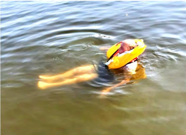
Das Ergebnis war erstaunlich. Beide Rettungswesten funktionierten einwandfrei. Blitzschnell füllten sich die Luftkammern mit Pressluft und ich wurde in die Rückenlage gedreht.
